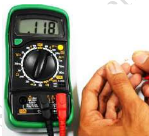
चित्र 4.23— प्रतिरोधक टर्मिनल को लाल और काले जांचों से स्पर्श कराकर प्रतिरोधक का प्रतिरोध मापना
