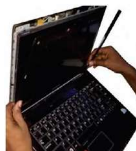
चित्र 3.78— एलसीडी स्क्रीन को सुरक्षित करने वाले चार स्कू निकालें चित्र 3.79— स्क्रीन बेज़ल निकालें
