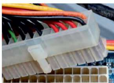
चित्र 3.46— 20-पिन ATX अनप्लग करें
