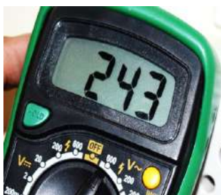
चित्र 4.29— होल्ड बटन का उपयोग करके डिस्प्ले में मान को होल्ड करना
