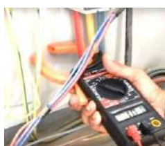
चित्र 4.19 — कंडक्टर के चारों ओर डिवाइस को क्लैप करें
