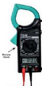
चित्र 4.17— क्लैप मीटर पर रोटरी चयनकर्ता सेट करना
