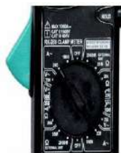
चित्र 4.18 — क्लैप मीटर को वोल्टेज पर सेट करना
