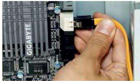
चित्र 3.8 SATA -डेटा केबल कनेक्ट करना चित्र 3.9— SATA डेटा केबल को मदरबोर्ड में प्लग करना
