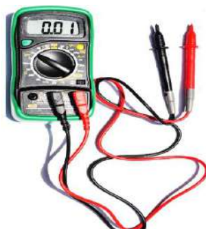
चित्र 4.25— लाल जांच को वोल्ट टर्मिनल से और काली जांच को सामान्य टर्मिनल से जोड़ना
