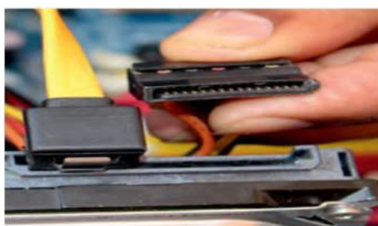
चित्र 3.20— एचडीडी में प्लग-इन 15-पिन कनेक्टर
