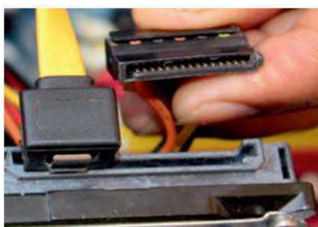
चित्र 3.41— एचडीडी से 15-पिन कनेक्टर को अनप्लग करें चित्र 3.42— एचडीडी से 7-पिन कनेक्टर को अनप्लग करें
