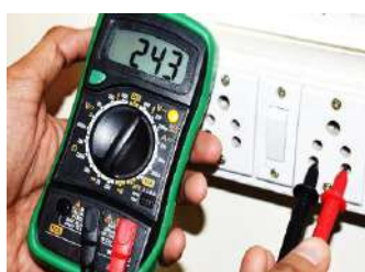
चित्र 4.27— मल्टीमीटर का उपयोग करके ऐसी वोल्टेज मापना
