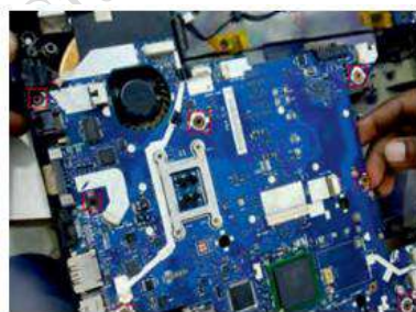
चित्र 3.74— मदरबोर्ड से केबल को डिस्कनेक्ट करें और स्कू निकालें
