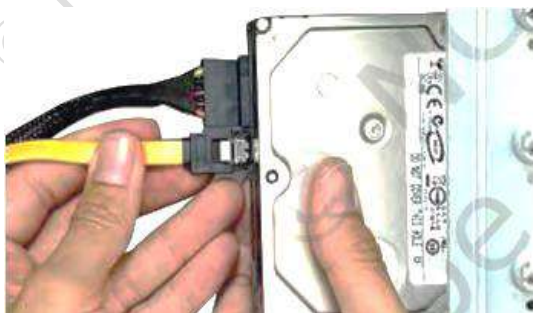
चित्र 3.8 SATA -डेटा केबल कनेक्ट करना चित्र 3.9— SATA डेटा केबल को मदरबोर्ड में प्लग करना
