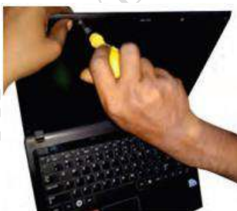
चित्र 3.78— एलसीडी स्क्रीन को सुरक्षित करने वाले चार स्कू निकालें चित्र 3.79— स्क्रीन बेज़ल निकालें
