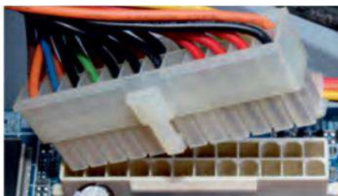
चित्र 3.18— 20-पिन ATX पावर कनेक्टर लगाना
