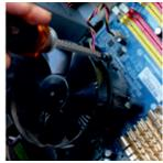
Fig. 12.43: Remove the system fan
