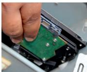
Fig. 12.12: Insert hard disk
